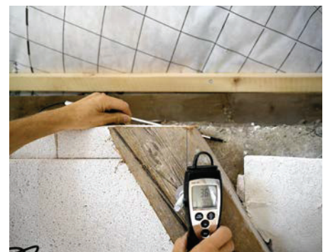
(12) Entgegen der Herstellerempfehlung wurde in diesem Fall die Innendämmung nicht vollständig aufgebracht. Das führt zu deutlichen Strömungen bei Unterdruck.
