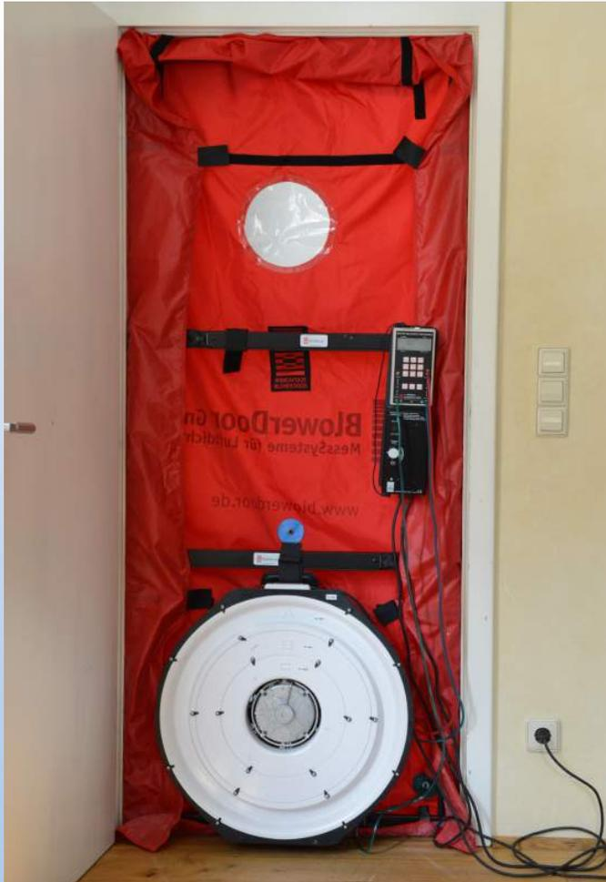
$$n_{50} = \frac{\text{Luftvolumen, das der Ventilator nach außen transportiert}}{\text{Netto - Luftvolumen des Hauses}}$$
