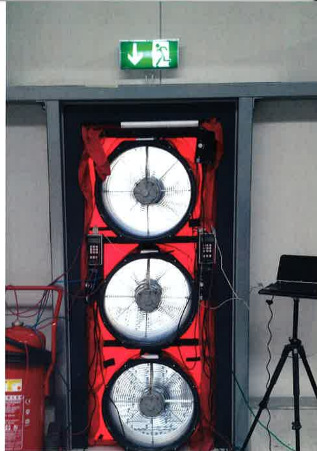
Links: In diesem KfW-Effizienzhaus 100 in Heidelberg-Pfaffengrund musste nach der ersten Luftdichtheitsmessung nachgebessert werden.
